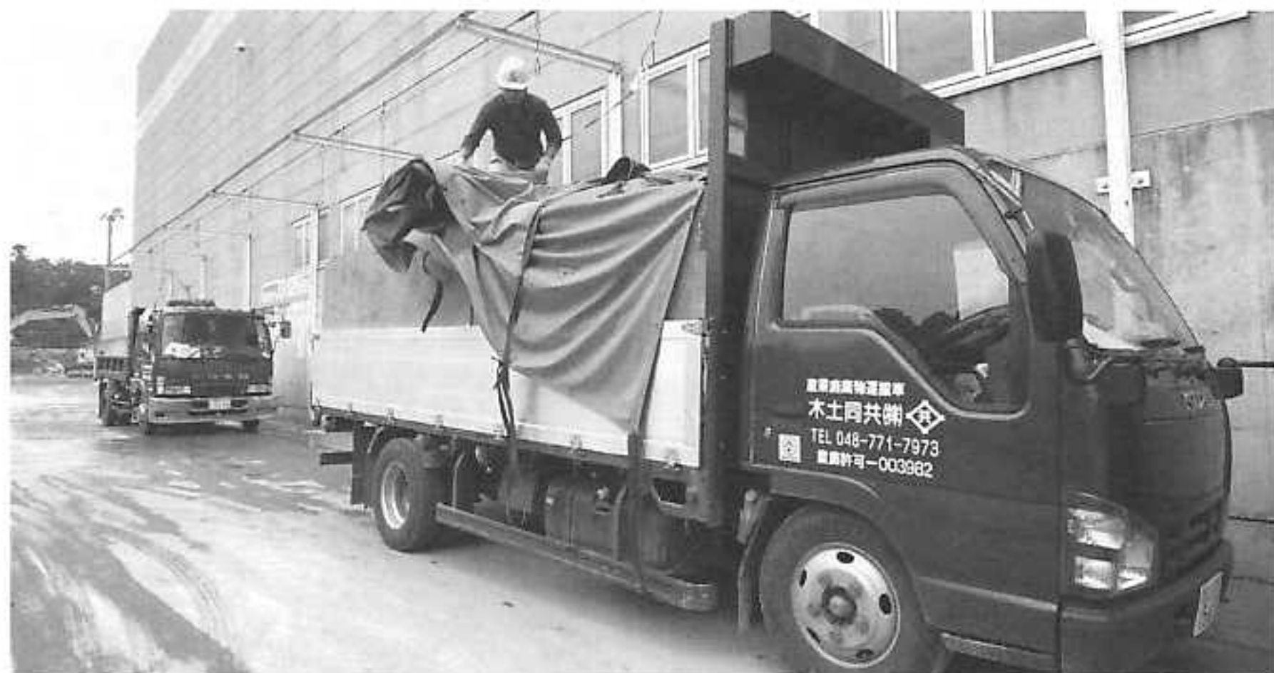
高所作業用安全帯をつけて積荷のカバーを外す作業員（於：共同土木・千葉工場）
