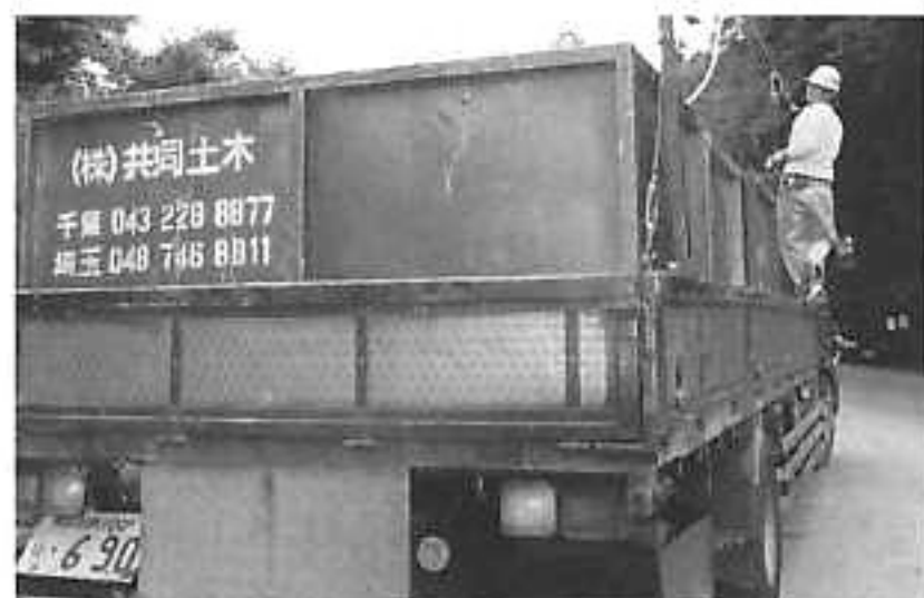
巡回回収の際は荷台の2カ所に柱を建て、そこにロープを張って高所作業用安全帯をつけて作業を行う
